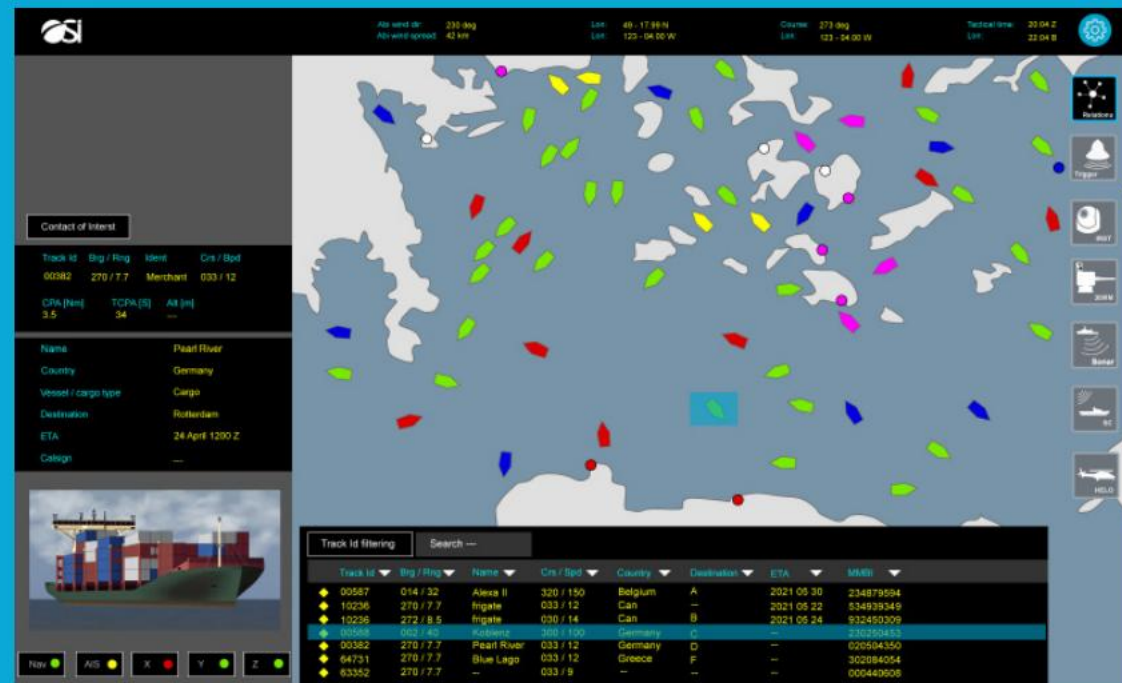
Giao diện MMS điển hình cho người dùng đồ họa không tham gia tác chiến trực tiếp sử dụng ký hiệu theo dõi AIS dân sự và hiển thị bản đồ quan hệ dữ liệu .
